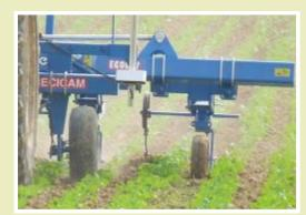
Binage du colza, guidé par caméra
